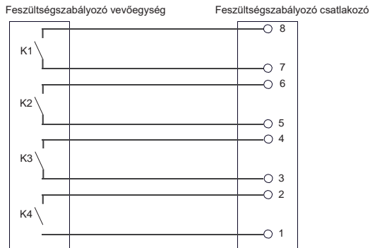
8-54. ábra: Feszültségszabályozó csatlakoztatási séma
